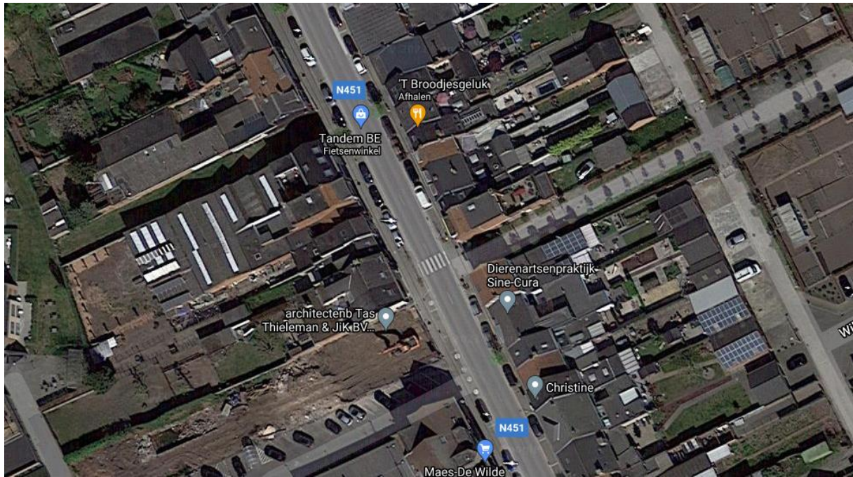
Figuur 16: Luchtfoto van de Dorpsstraat in Kieldrecht. De rijhuizen zijn gemiddeld gezien erg ver uitgebouwd, wat het rendement van afkoppelingswerken beperkt: er blijft na afkoppelen veel oppervlak aangesloten op de gemengde leiding.
