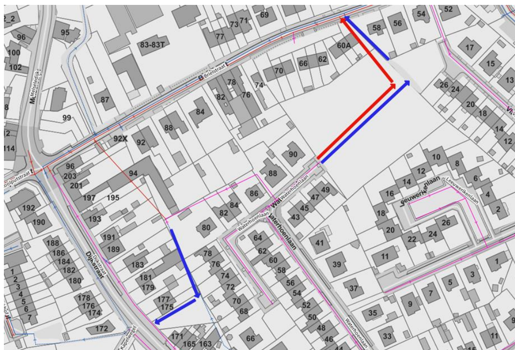
Figuur 3: De afvalwaterleiding onder Brielstraat nr 94 vangt zowel water op van een gracht (waar mogelijk nog lozingen op zitten), als van de gemengde riolering die van de Waterhoenlaan komt. Bij ontwikkeling van perceel 887S moet dit probleem aangepakt worden. De pijlen geven de voorkeursrichtingen aan: de gracht wordt afgekoppeld rechtstreeks naar de Dijkstraat tussen nr. 171 en 175. Hier wordt best ruimte voor zichtbare afwatering behouden. Een andere mogelijkheid is een open bedding richting Brielstraat waar reeds RWA aftakking klaar zit richting waterloop De Waterhoenlaan krijgt een gescheiden doorvoer naar de bestaande aansluitpunten in de Brielstraat tussen huisnummer 58 en 60.
