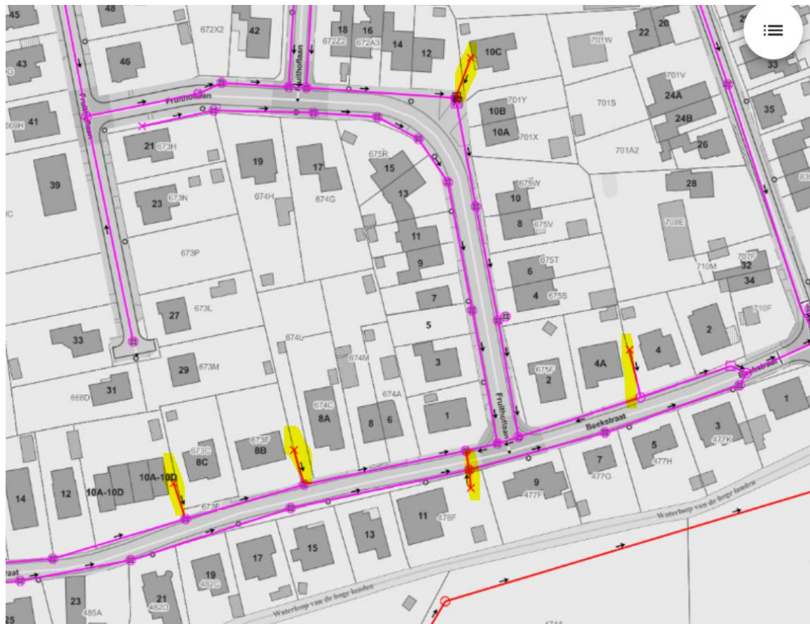
Figuur 13. Drainageaansluitingen langs de Beekstraat en in de Fruithoflaan die mogelijk kunnen worden afgedicht.
