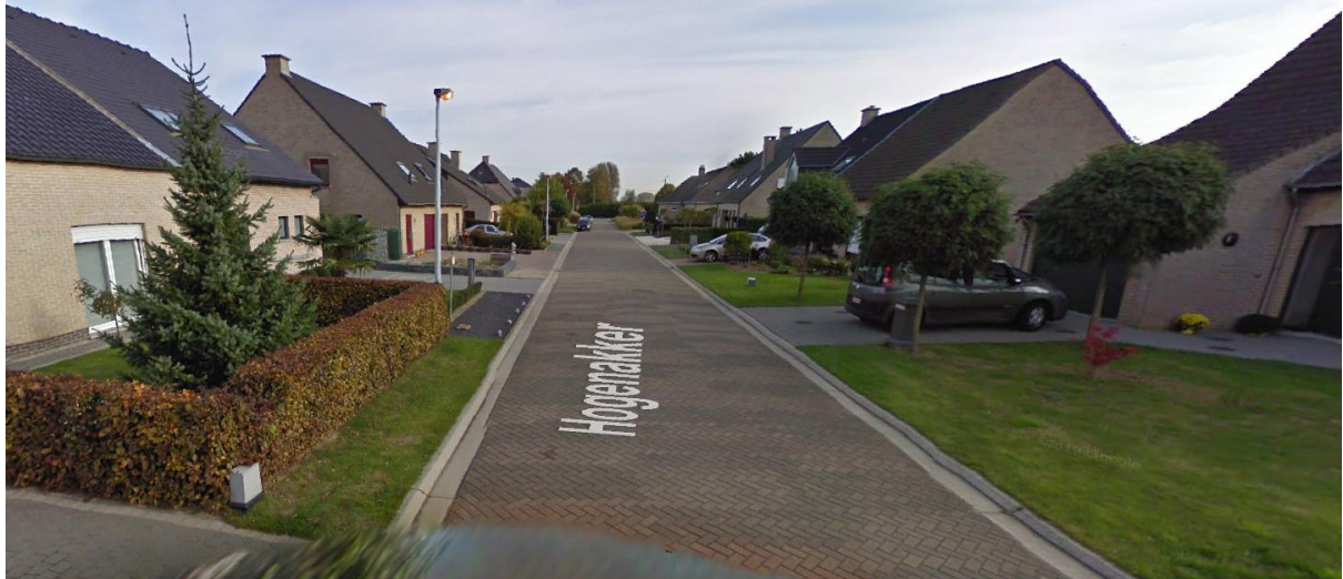
Figuur 10. Vlakbij zien we deze straat waar de voetpaden zijn weggelaten, wat geen enkel probleem lijkt op te leveren . We zien hier wel boordstenen die infiltratie voorkomen en privatisering van de bermen: doordat de berm geen functie lijkt te hebben, wordt hij door bewoners geclaimd door het aanleggen van (half) verharding om onderhoud te vereenvoudigen of extra parkeerplaats te genereren.
