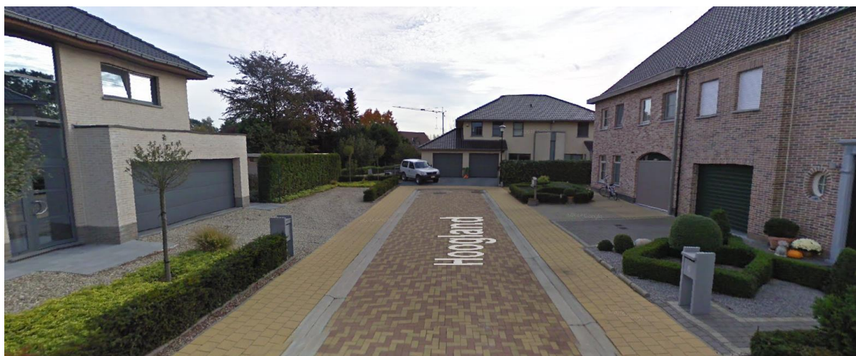
Figuur 9. Een extreem voorbeeldje van een korte doodlopende straat, waar voor 4 woningen een rijweg en twee voetpaden werden voorzien. De voetpaden zijn hier niet nodig en nodigen hoogstens uit tot asociaal rijgedrag.
