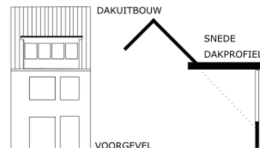
Figuur 9: voorgevel en snede van een dakuitbouw
